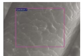
Analisi elementale ai raggi X durante visualizzazione al SEM: contenuto di calcio sulla superficie del capello dopo deposizione di calcare e trattamento con REGENINE 1% p/p
